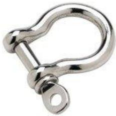
Цепь присоединяется к якорю и к канату мочками. Винтовой замок мочки имеет отверстие для установки шплинта или кольца из нержавеющей проволоки, предотвращающего самопроизвольное выкручивание замка. Это **ЖИЗНЕННО ВАЖНО** и должно постоянно проверяться. Самые прочные в мире якоря и якорные канаты становятся бесполезными, если мочка отсоединилась.
