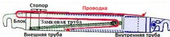
**Выбор стаксель реи:** Не следует путать стаксель рею со спинакер гиком (реей), длина которого определяется J – размером (расстоянием от основания штага до мачты). Базовая длина стаксель реи должна быть равна длине нижней шкаторины установленного паруса. Для лодки, на которой используется набор
