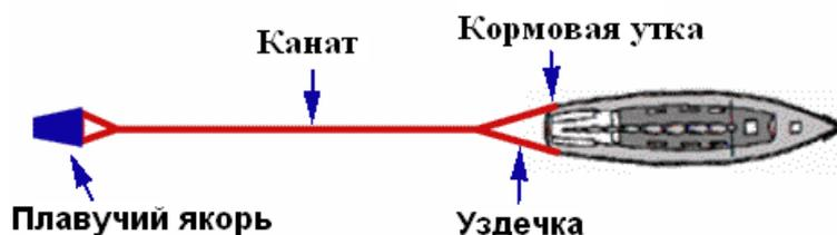
Плавающий якорь должен устанавливаться на таком расстоянии, чтобы оказаться сзади у основания волны, когда лодка оказывается на ее гребне.
