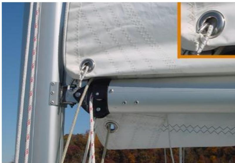
В сильный ветер зацепление люверса за крюк может быть затруднительным, поскольку выполнившему это действию члену экипажа затем требуется несколько секунд для набивки грота фала, в течение которых сильный ветер может сорвать люверс с рифового крюка.
